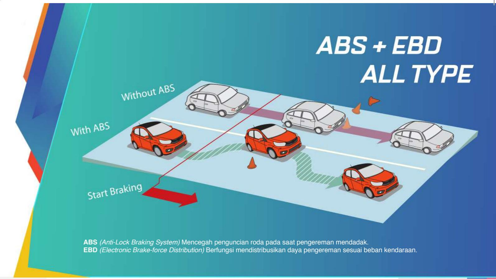
**ABS (Anti-Lock Braking System)** Mencegah penguncian roda pada saat pengereman mendadak.
